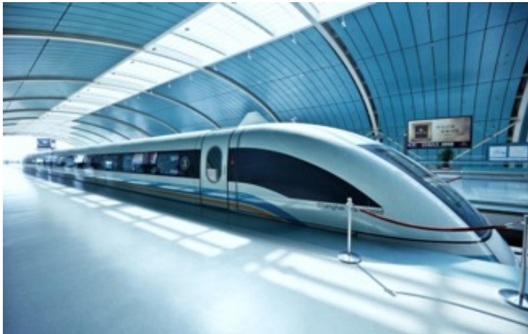
الشكل 4. قطار المستقبل: يطفو القطار على القضبان باستخدام تأثير مسنر، لكن يتطلب ذلك تطوير مواد فائقة التوصيل في درجة الحرارة العادية.
