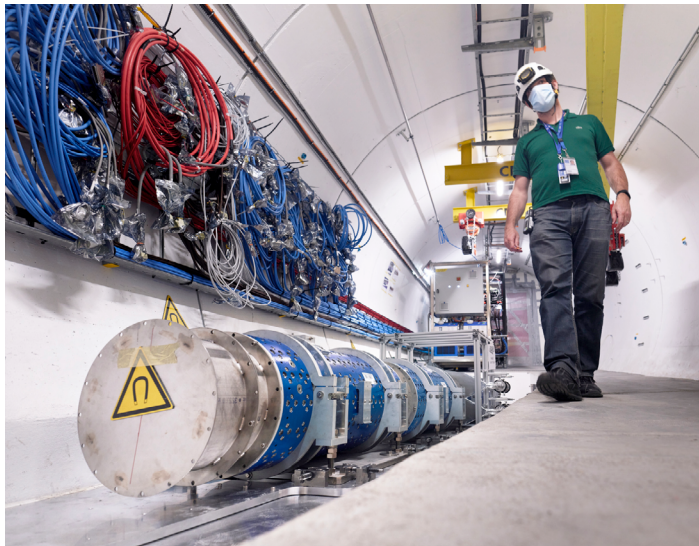
تجربة FASER: ForwArd Search ExpeRiment في الـ LHC للبحث عن جسيمات خفيفة وضعيفة التأثير، مثل النترينوات. CERN
